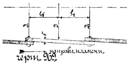
а потому  $tg \alpha = \frac{\delta}{l}$ , если  $\delta$  — толщина стѣнки,  $D$  — средній діаметръ барабана, а  $l$  — разстояніе поперечныхъ заклепочныхъ швовъ, между осями заклепокъ. Направленіе пламени указано на чертѣжѣ.
